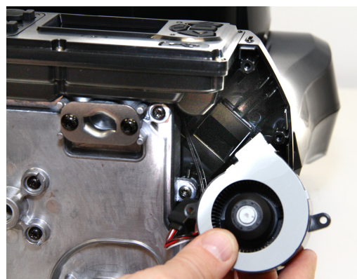
Figure 11: Déplacement de la turbine
