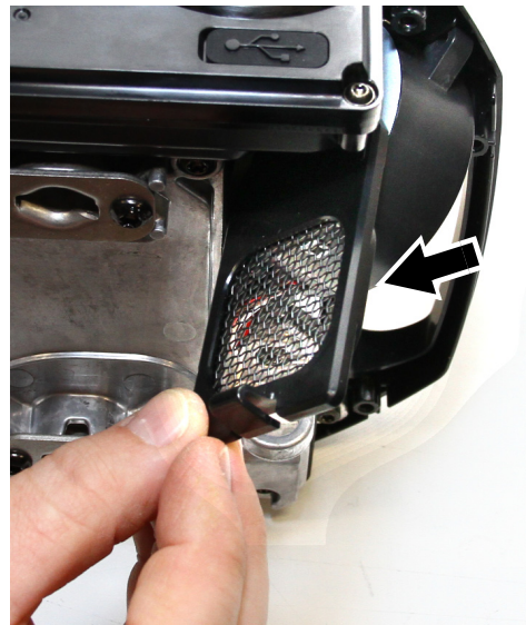
Figure 12: Démontage du filtre
